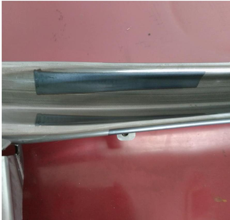
写真 半導体レーザーによる熱処理
